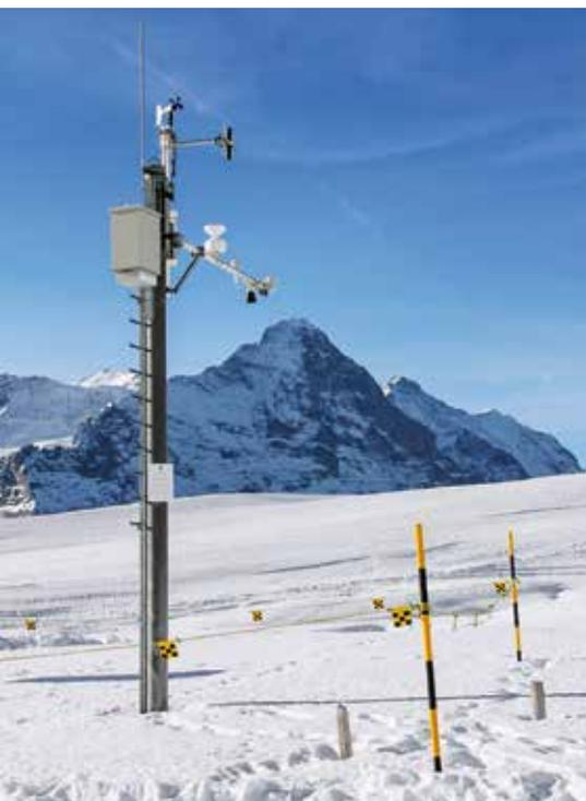
Schmidigen-Bidmeren sopra a Grindelwald è una delle 177 stazioni di misurazione automatica che forniscono dati 24 ore su 24.
