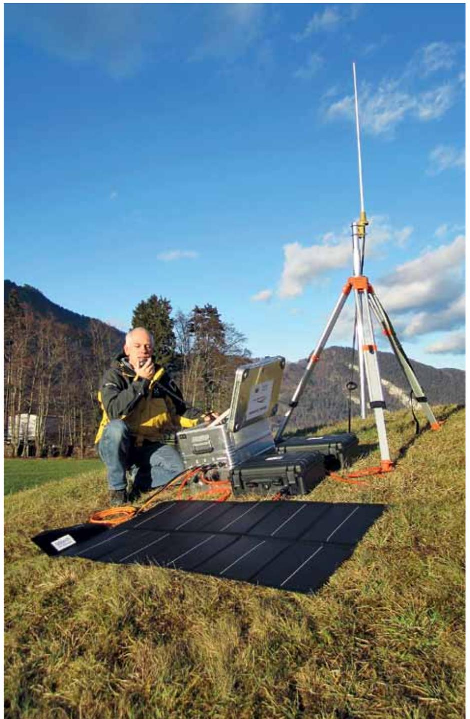
Montata e pronta all'uso: la valigetta in alluminio con ricevitore e trasmettitore, l'antenna, due valigette con batterie al Piombo Gel e il pannello solare. Immagine: per conc.
